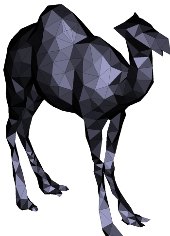
(b) Malha simplificada com 1128 triângulos, DI, r=0.05
