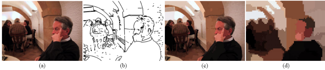
Figura 2.9: (a) imagem original; (b) detecção de silhuetas; (c) segmentação de cor; regiões contínuas de cor sólida nesta imagem representam elementos individuais de segmentação; (d) segmentação de cor numa escala grosseira.
