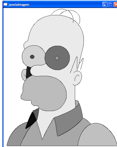
Figura 2.4: Rotulação feita com o uso de componentes conexas.
